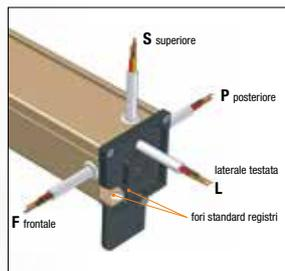
Tipologie uscita cavo motore e
