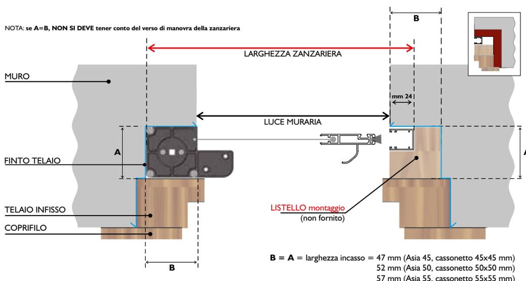
**SCHEDA TECNICA 05** Per gli altri modelli a raccolta laterale del telo (a molla), l'altezza finita della zanzariera è uguale all'altezza luce del vano finestra + 37 mm (altezza della guida).
