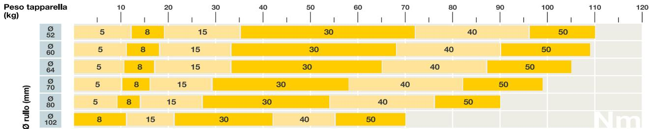
**Tapparella con doghe di spessore max. 14 mm e altezza max. 55 mm.
