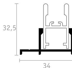
TELAIO 2 VIE CON COMPENSATORE
