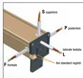
Tipologie uscita cavo motore e
