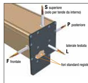
Uscite cavo motore e posizione registri
